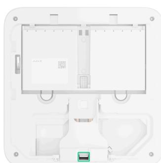
**3.** Schließen Sie Ethernet- und Stromversorgungs-Kabel an die entsprechenden Klemmen an.
